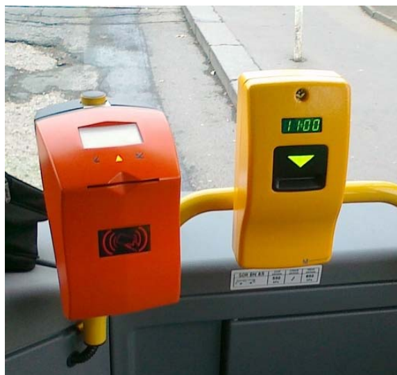
Obrázek 5 Čtečka BČK s výdejem papírových jízdenek FCU 800 (vlevo) a klasický označovač papírových jízdenek Mikroelektronika NJ 24C [4]
